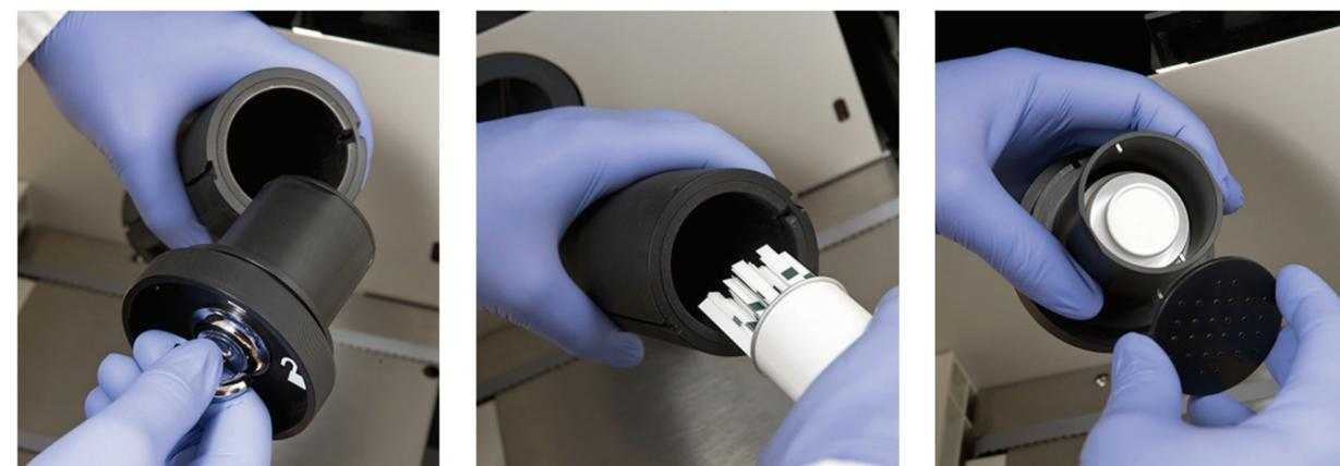
La alimentación del contenedor de tiras reactivas se realiza directamente desde el tubo de tiras CombiScreen® 11 Auto. El desecante en la tapadera se puede utilizar para asegurar la estabilidad de humedad dentro del contenedor.
